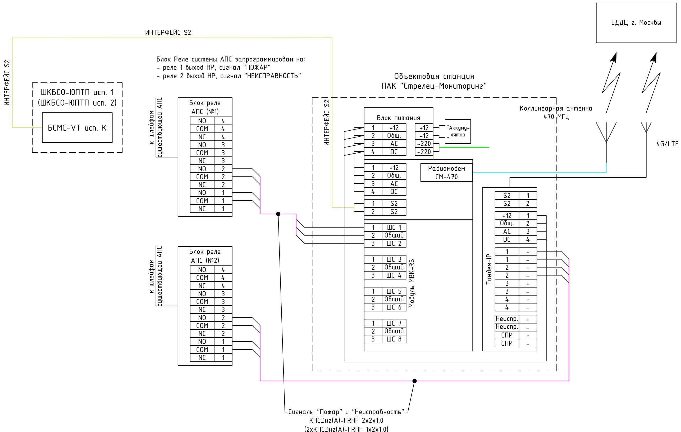
Схема коммутации оборудования дублирования сигналов о пожаре в ЕДДЦ г. Москвы
